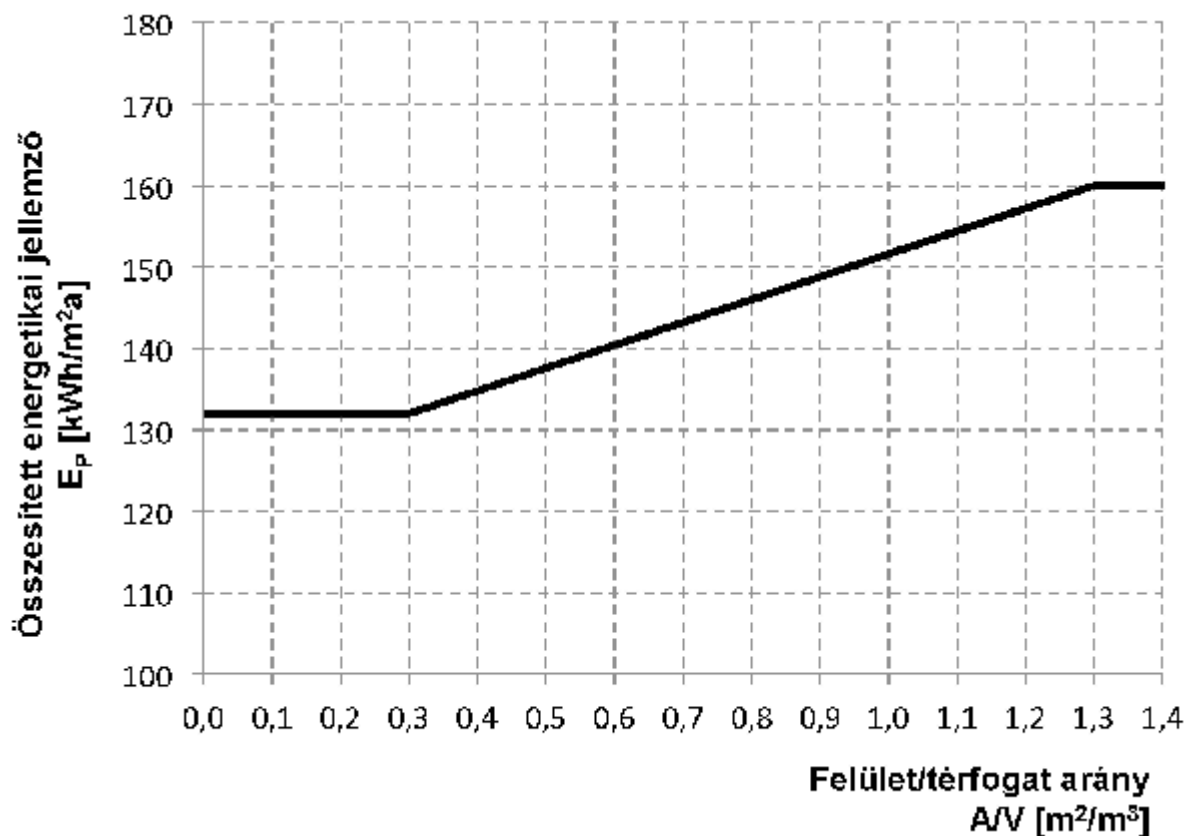
1. ábra. Irodaépületek összesített energetikai jellemzőjének követelményértéke (a világítási energia igényt is beleértve)
